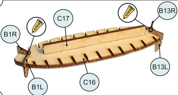
3. Склейте кондуктор (C16+C17). Вставьте шпангоуты B1L и B1R и зафиксируйте их каплей клея в центральной части, не клея к кондуктору. Аналогично для шпангоутов B13L и B13R.
